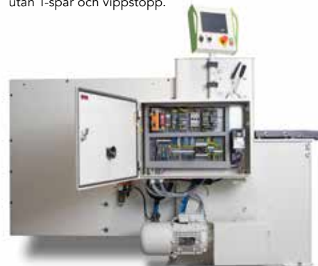
Servicevänlig med lätt åtkomst till styrning, elskåp, elektronik och luft.
