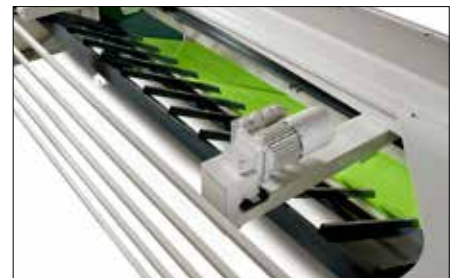
Plåtupphållare nere för leverans till framsidan, rörelsen styrs via CutLink.
