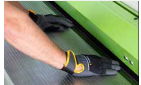
Plättillhållarens placering endast 32 mm från klipplinjen leder till minimalt med spill.
