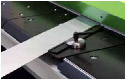
EVO DUO har 360° ställbart vinkelanslag med tydlig gradskala för snedklipp (tillval).
