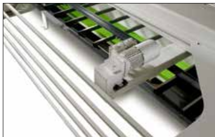
Plåtupphållare uppe, tillräckligt avstånd mellan kulskrivarna med plats att dra en 1250 mm plåt igenom (ej RAPIDO 13).
